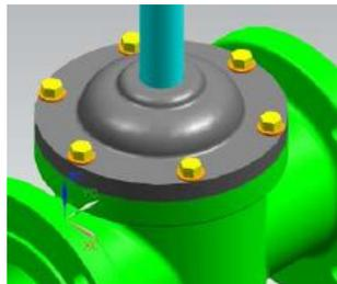
16. Измените количество отверстий в детали *des02\_valve\_yoke* с 6 на 8. Посмотрите на то, как изменится массив компонентов.
