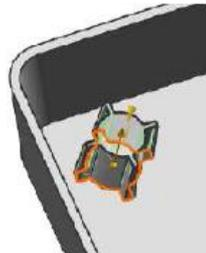
7. Создайте линейный массив из полученного элемента «Вытягивания» с параметрами 22мм и 45мм.
